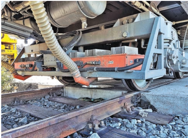
Slika 5. Spoljašnja jedinica beskontaktnog mernog sistema
