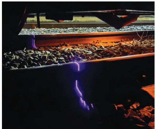
Slika 6. Laserski snop na šini vidljiv ljudskim okom u tamnim uslovima sistema
