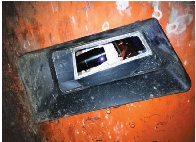
Slika 5. Spoljašnja jedinica beskontaktnog mernog sistema
