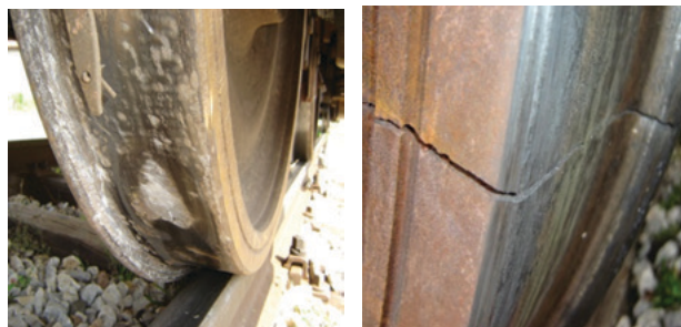
Slika 1. Oštećenja bandaža točka
