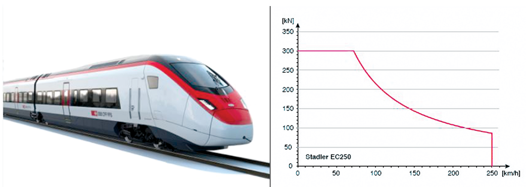
Slika 5. Dijagram vučna sila/brzina EC voza EC250 SBB
