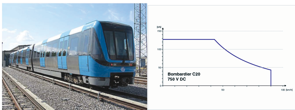
Slika 6. Dijagram vučna sila/brzina metro voza Bombardier C20
