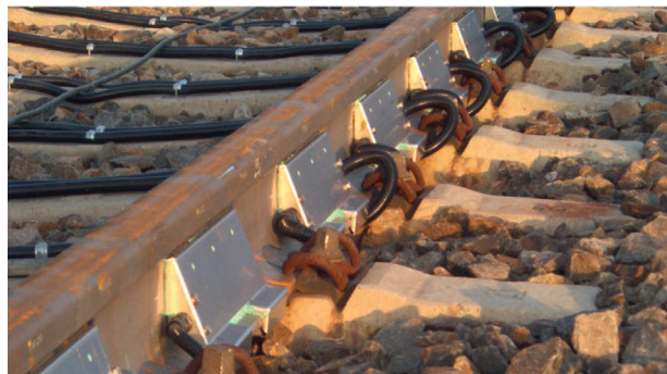
Slika 7: Prikaz dizajna vanjske opreme dinamičke vage
