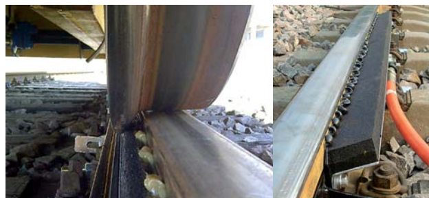
Slika 13. Ispravno podmazivanje dodira venca točka/šina
