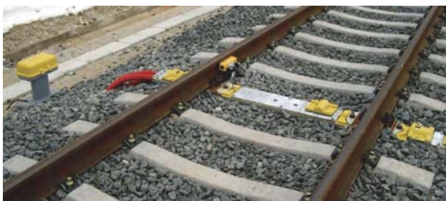
Slika 9. Detektor FÜS II za otkrivanje pregrijanih točkova, ležaja i blokiranih kočnica [5]
