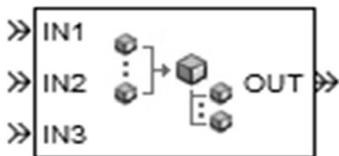
Slika 7. Entity Combiner blok generiše jedan novi entitet za svaki niz entiteta koji dolaze u ovaj blok kroz nekoliko ulaznih portova
