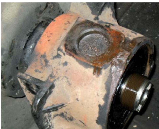
Slika 4. Prikaz kućišta pregrejanog ležišta (Izvor: SI CIP [2])
