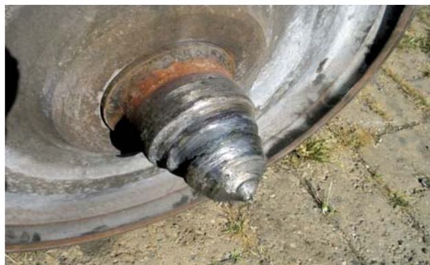
Slika 2. Deformacija rukavca osovine usled pregrejanosti (neispravnosti ležaja) (Izvor: SI CIP [2])
