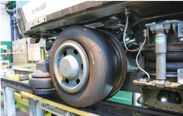
Slika 4. Prikaz gumenog točka nekonvencionalnog šinskog sistema [7]
