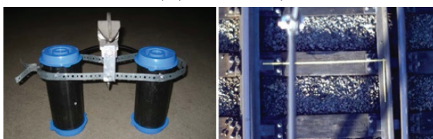
Slika 27. Prototip CCD kamere montiran na nadzemnoj liniji (levo) i uzorak slike (desno)
