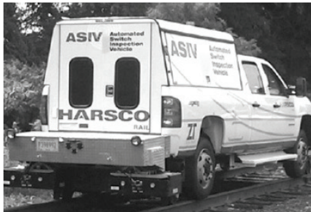
Slika 22. ASIV vozilo, ZETA-TECH [9]
