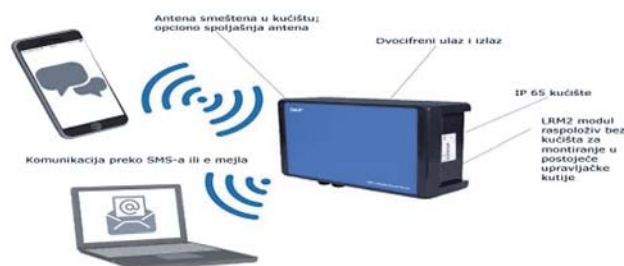
Slika 16. LRM2 uređaj za daljinsko praćenje podmazivanja (Izvor: SKF-LINCOLN [17])
