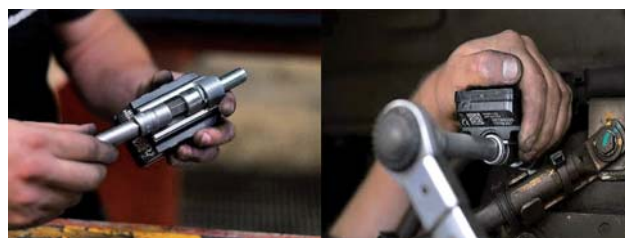
Slika 7. Montaža SKF Insight Rail senzora (Izvor: SKF)
