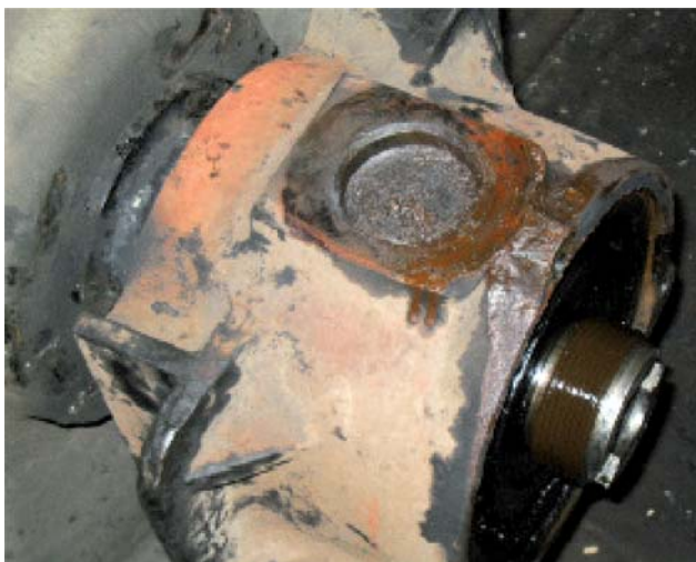
Slika 4. Prikaz kućišta pregrejanog ležišta (Izvor: SI CIP [2])
