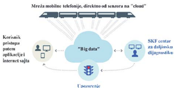
Slika 8. Daljinsko praćenje stanja lokomotive 441-06 TENT Obrenovac (Izvor: SKF)
