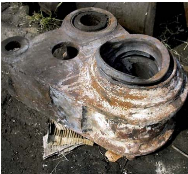
Slika 3. Deformacija kućišta ležaja usled pregrejanosti (neispravnosti ležaja) (Izvor: SI CIP [2])
