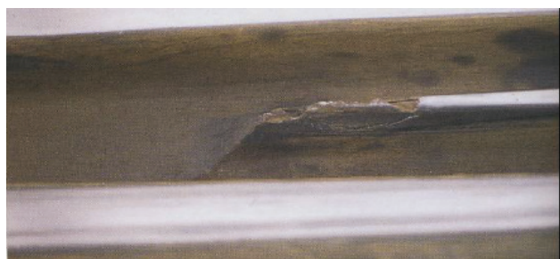
Slika 12. Oštećenje vrha srca ukrštaja [4]
