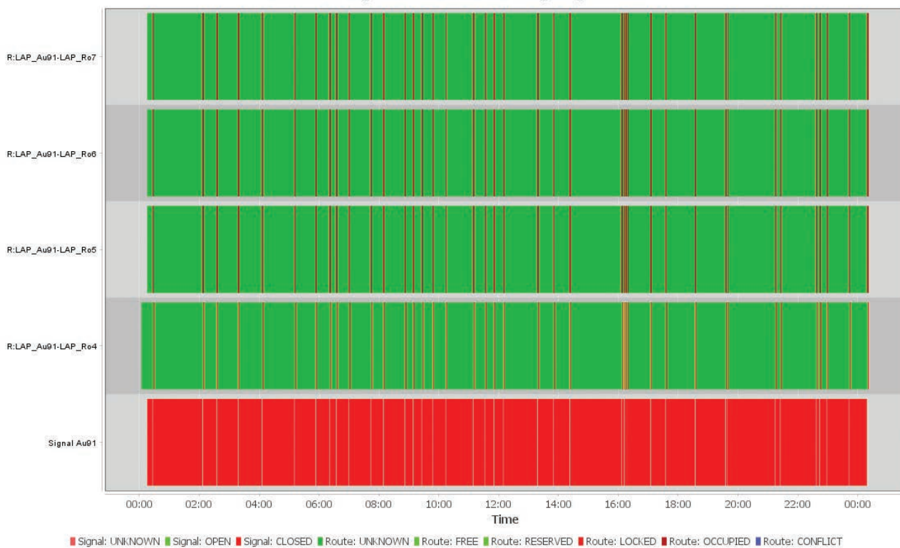
Slika. 18. Status signala stanice Lapovo pri postojećem stanju
