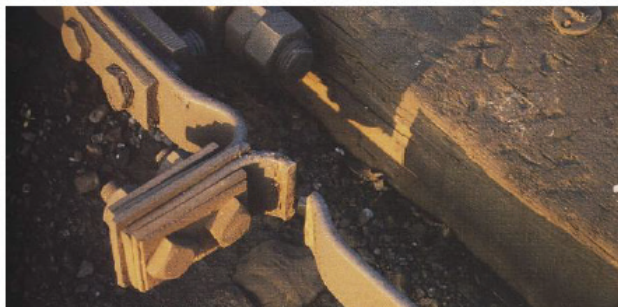
Slika 4. Polomljena potezna šipka mehanizma [4]
