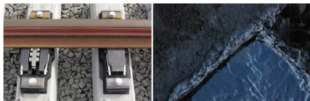
Slika 13. Klizalice kompanije Voestalpine (levo) i suvi klizni jastučić (desno) [9]
