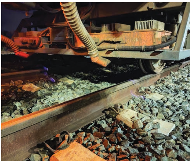
Slika 6. Laserski snop na šini vidljiv ljudskim okom u tamnim uslovima sistema
