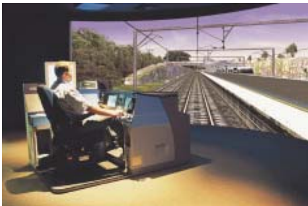
Slika 2. Konzola za simulaciju vožnje voza 3
